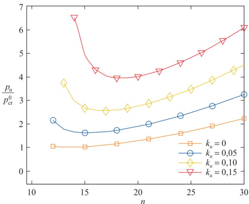
Рис. 2. Зависимость нагрузки  $\frac{P_n}{P_{cr}^0}$  от волнового числа  $n$  в форме потери устойчивости для однородной пластины ( $P_{cr}^0$  – критическая нагрузка, соответствующая однородной круглой пластине при  $k_u = 0$ )
