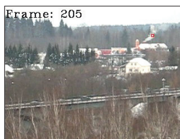
Рис. 5. Кадры используемых видеопоследовательностей с результатами обнаружения блоков дыма размером 5 \times 5 пикс Fig. 5. Results of detecting smoke blocks with size of 5 \times 5 pixels
