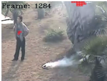
Рис. 6. Примеры кадров видеопоследовательностей с ложным обнаружением: a – при движении видеокамеры; б – при наличии движущегося человека; в – при наличии движущейся машины
