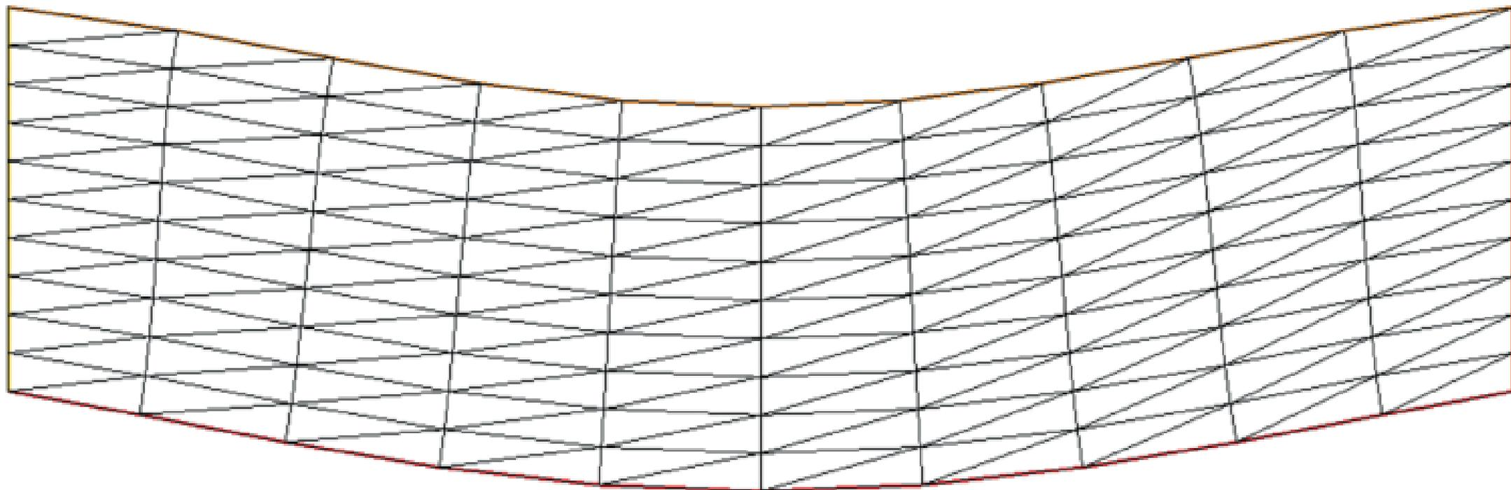
*Рис. 7.* Изгиб балки под действием собственного веса
