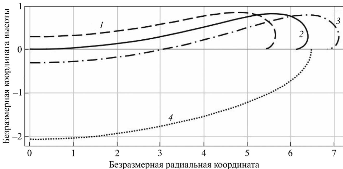
*Рис. 4.* Равновесные меридианные кривые при первом параметре формы, меньшем, чем первая критическая форма (1), равном ей (2), большем, чем первая критическая форма, но меньшем, чем вторая (3), большем, чем вторая критическая форма (4)
