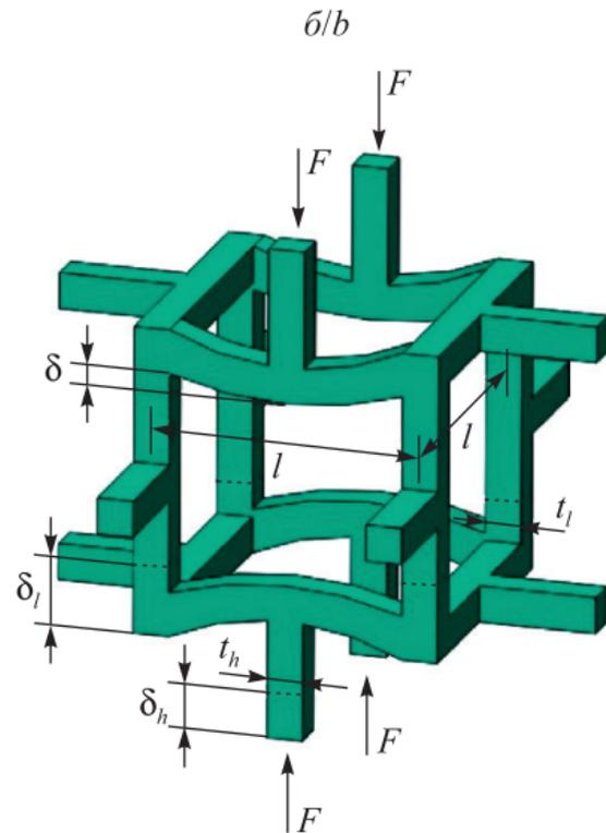
Рис. 1. Математическая модель пористой структуры с открытыми порами, состоящая из  $n$  вертикально и  $m \times k$  горизонтально расположенных МГЭ (а).
