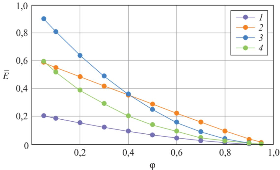
Рис. 2. Графики зависимости относительного модуля Юнга  $\bar{E}$  от пористости образца  $\phi$  с открытыми порами: 1 –  $C_1 = 8$ ; 2 –  $C_1 = 192$ ; 3 – соотношение Гибсона – Эшби; 4 – интерполяция результатов *GeoDict*
