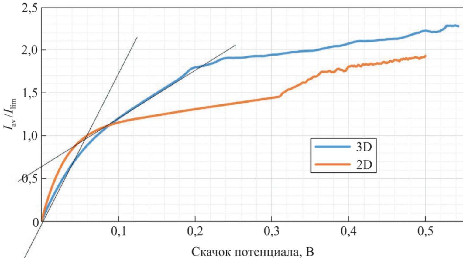
Рис. 6. Вольт-амперные кривые для трехмерной и двумерной моделей
