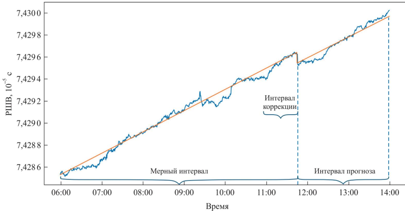
Рис. 4. Графическая иллюстрация двухэтапного подхода к построению модели прогноза РШВ по апостериорным данным РШВ космического аппарата R01 (см. рис. 1)
