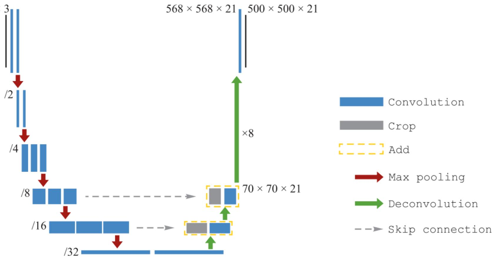
Рис. 1. Структурная схема архитектуры FCN-8
