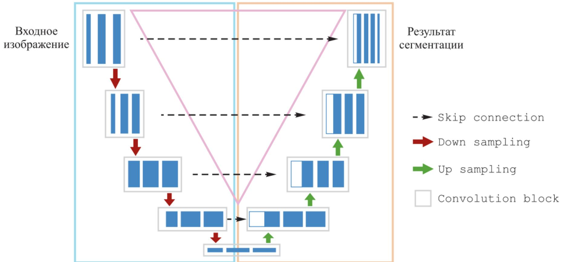
Рис. 2. Структурная схема архитектуры U-Net
