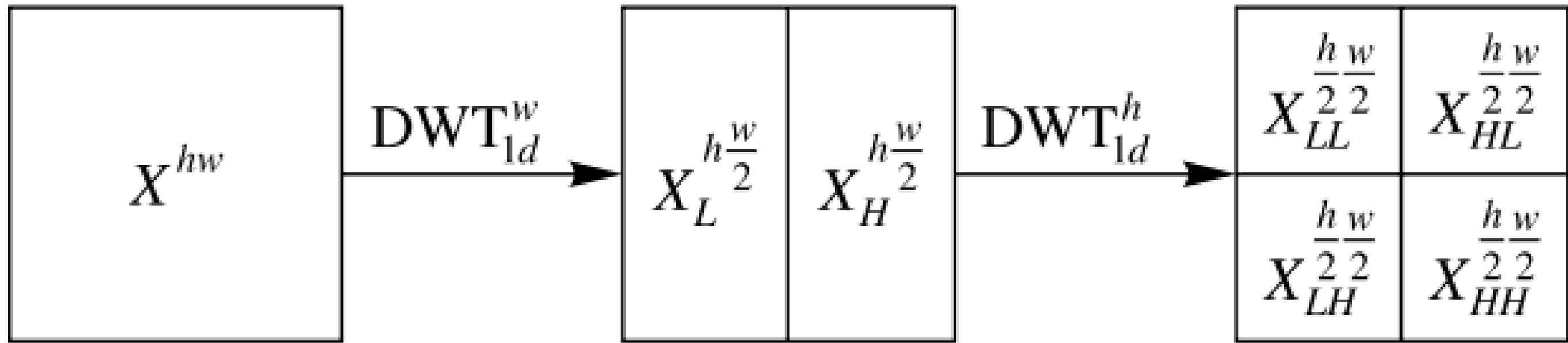
*Рис. 1. Двумерное дискретное вейвлет-преобразование*
