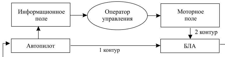
Структурная схема управления БЛА Control block diagram of UAV
