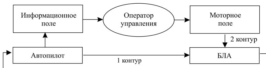
Структурная схема управления БЛА
