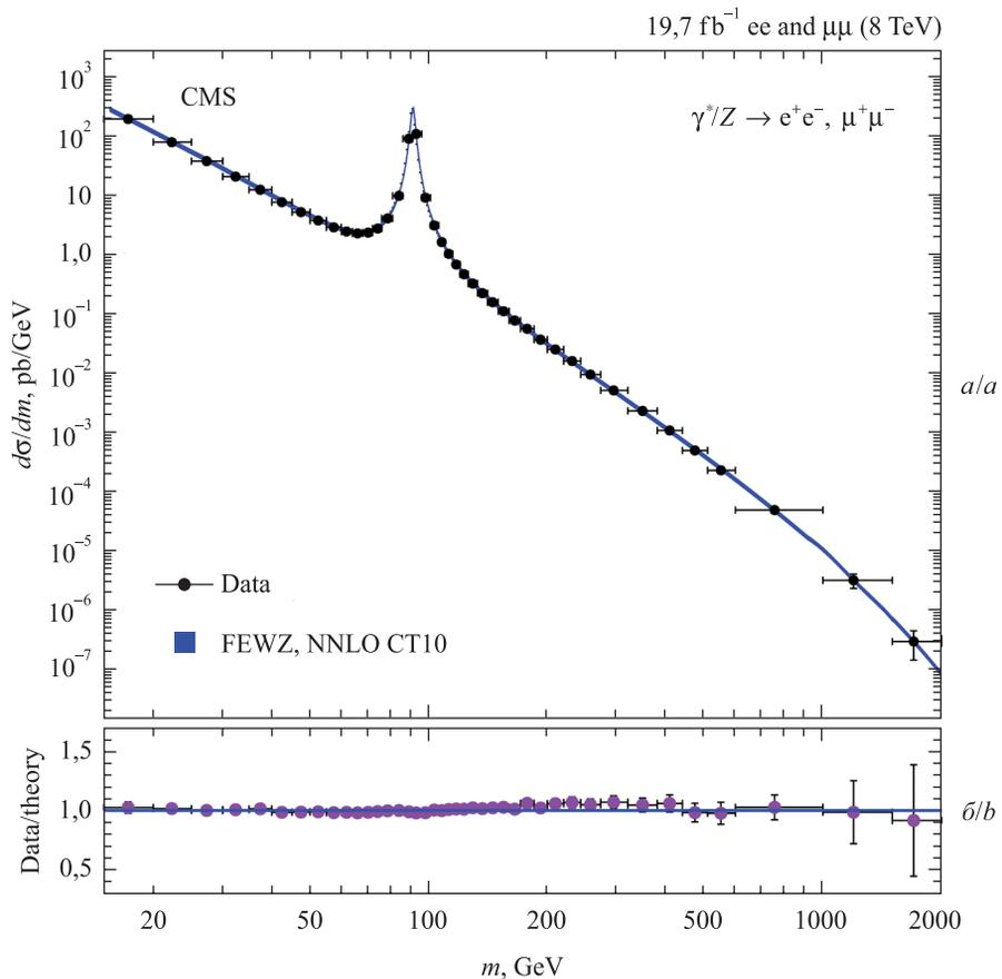
Рис. 2. Дифференциальное сечение  $\frac{1}{\sigma_Z} \frac{d\sigma}{dm}$  рождения пар лептонов ( $\mu^+\mu^-$  и  $e^+e^-$ ) в процессах Дрелла – Яна [8] (а); сравнение экспериментальных данных и предсказаний СМ в NNLO (б)
