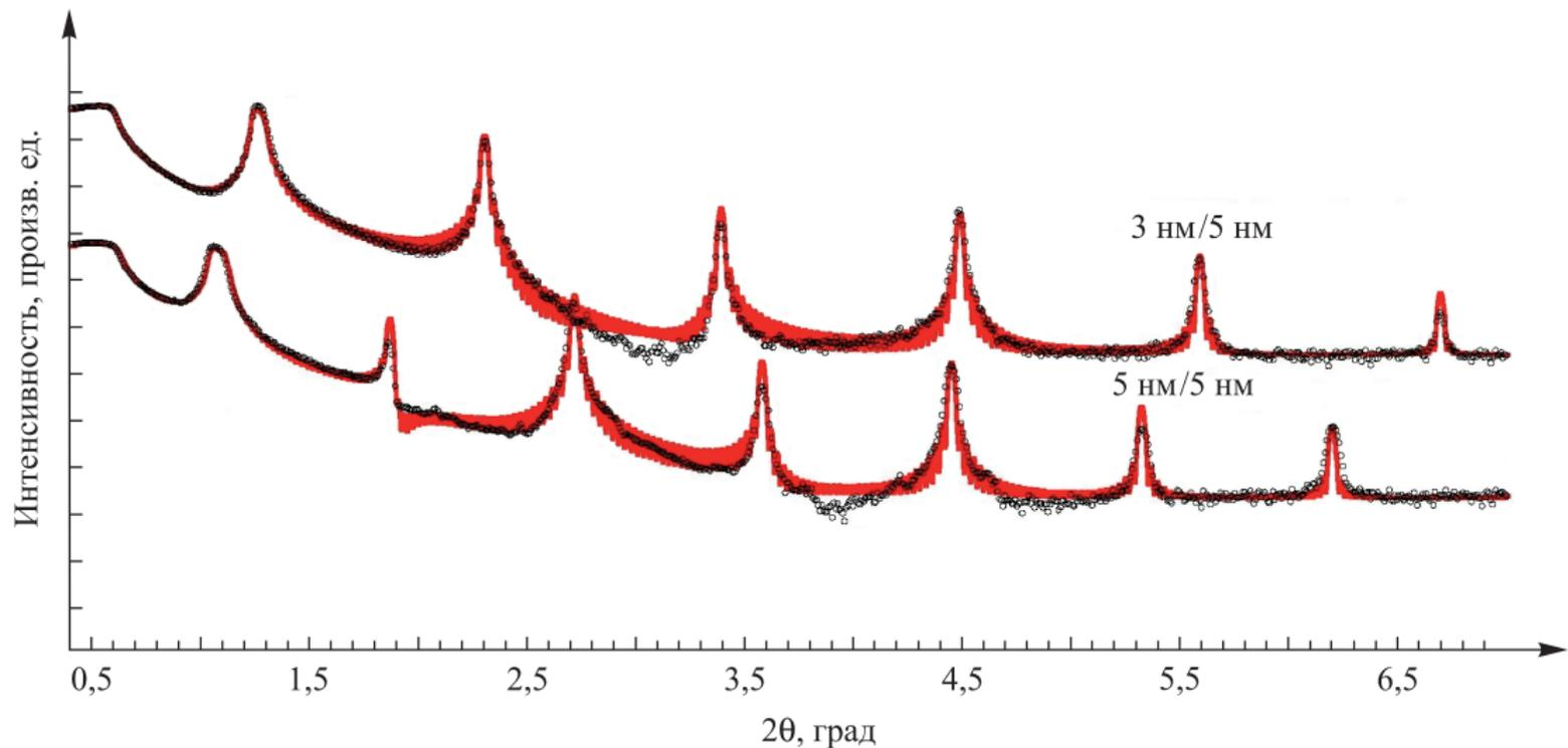
*Рис. 1.* Экспериментальные XRR-спектры многослойных покрытий  $ZrN/SiN_x$  с различным соотношением толщин слоев  $ZrN$  и  $SiN_x$  (темная линия), а также спектры, полученные в результате моделирования (красная линия) [17]
