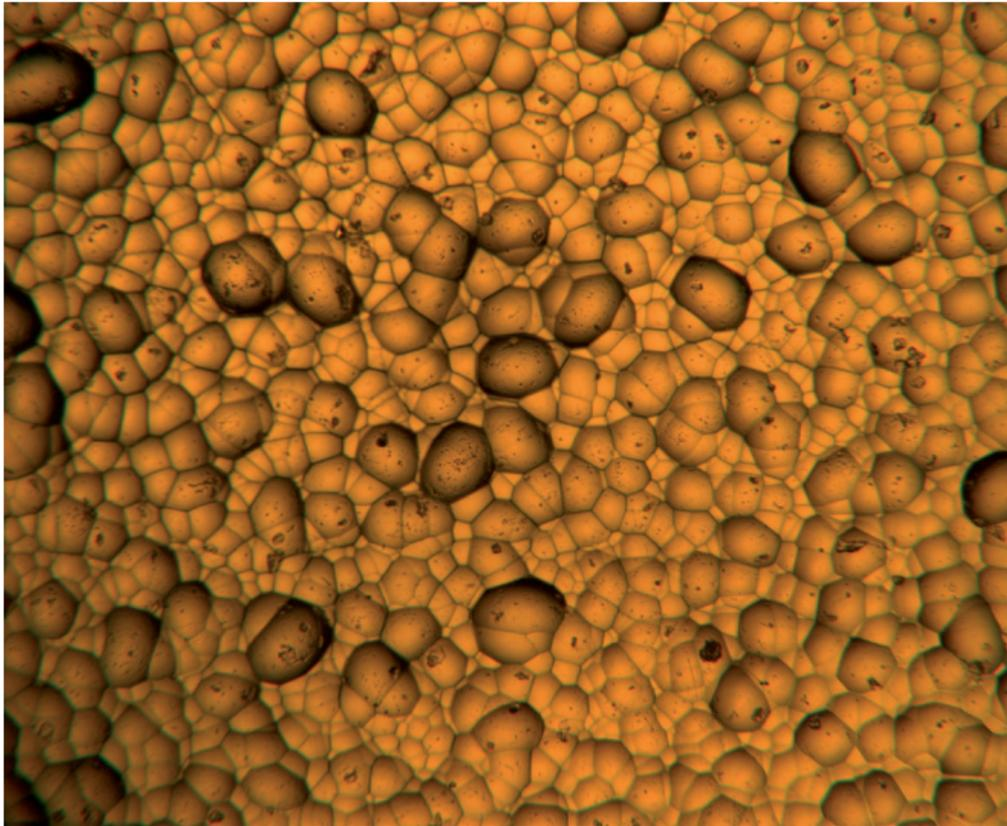
*Рис. 3.* Поверхность аperiodического линзового раstra при 10-кратном увеличении
