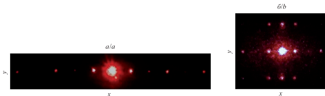
Рис. 5. Дифракционная картина одномерной (a) и двумерной (b) анизотропных фазовых ЖК-решеток
