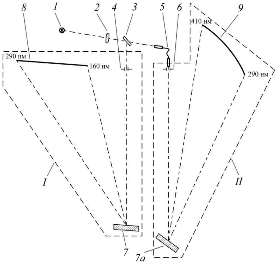
Рис. 3. Оптическая схема прибора, включающая спектральный блок
