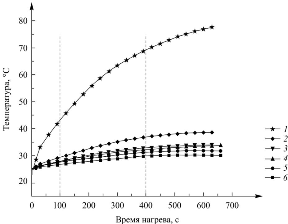
*Рис. 4.* Кривые нагрева сердечников композиционного магнитно-мягкого материала при постоянной напряженности магнитного поля (3 кА/м) на основе порошка ASC100.29 ( $d < 0,1$  мм) со средней толщиной изоляции 1 нм на частоте 1 кГц (1), 5 кГц (2), 10 кГц (3), 25 кГц (4), 50 кГц (5) и 100 кГц (6)
