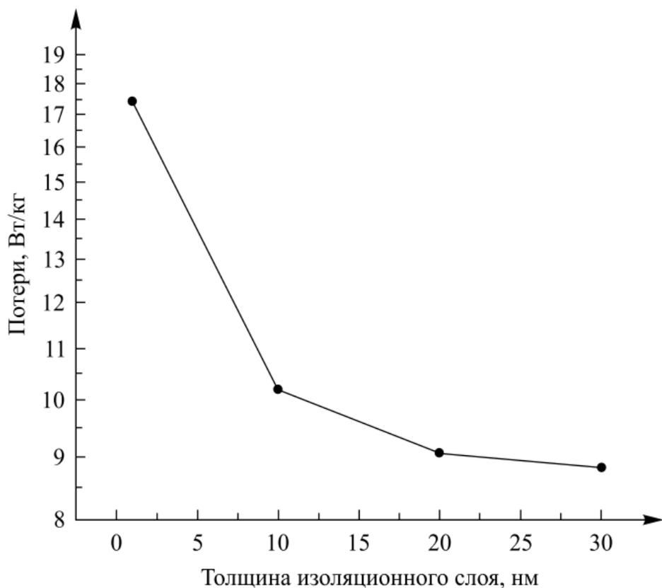
*Рис. 7.* Зависимость величины удельных потерь от толщины изоляционного покрытия на частоте 10 кГц при изменении индукции, равном 0,25 Тл
