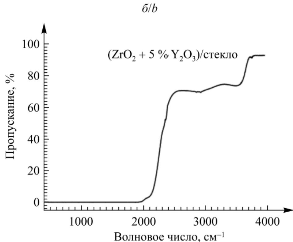
*Рис. 7.* Спектр пропускания пленки оксида циркония  $ZrO_2 + 5\% Y_2O_3$  на стеклянной подложке в видимой, ближней ИК (*a*) и средней ИК (*б*) области
