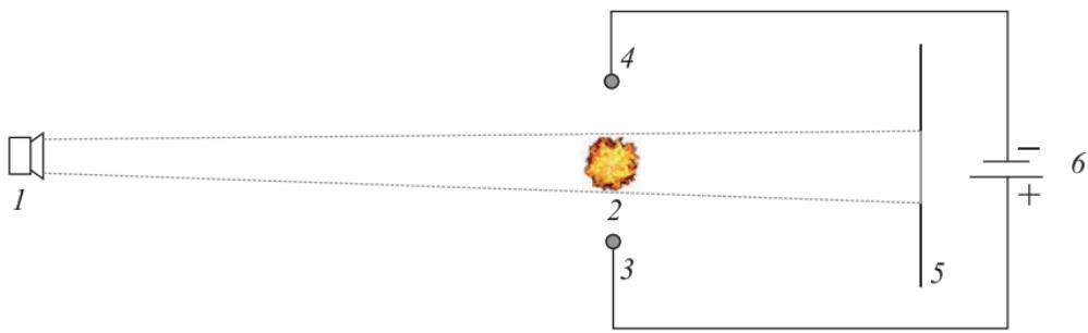
*Рис. 1. Схема используемой установки: а – вид сбоку, б – вид сверху; 1 – камера, 2 – горючее тело, 3 – анод, 4 – катод, 5 – экран, 6 – источник напряжения*
