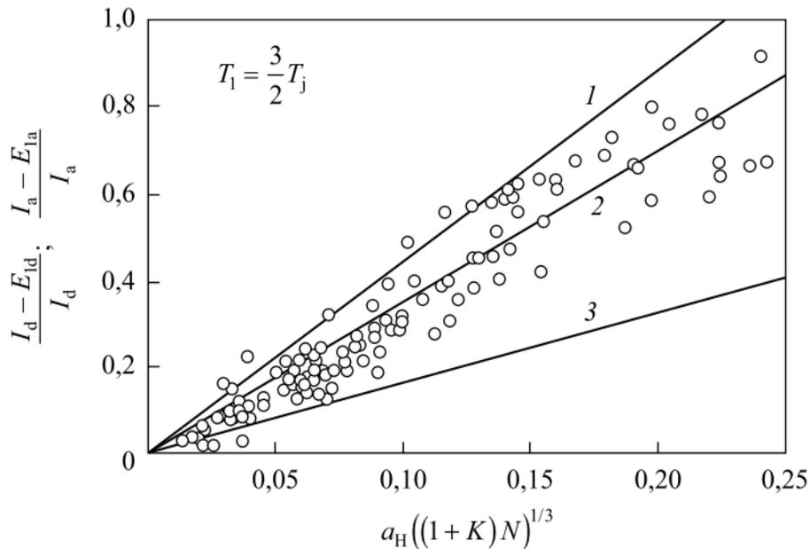
*Рис. 3.* Зависимость дифференциальной термической энергии ионизации водородоподобных доноров  $E_{1d}$  или акцепторов  $E_{1a}$  от их концентрации  $N$  и степени компенсации  $K$ : линии – расчет по формуле (25) для температуры  $T_1 \approx \frac{3T_j}{2}$  и степеней компенсации  $K = 0,01$  (кривая 1),  $K = 0,3$  (кривая 2),  $K = 0,5$  (кривая 3); точки – экспериментальные данные для полупроводников  $n$ - и  $p$ -типа [41–55]
