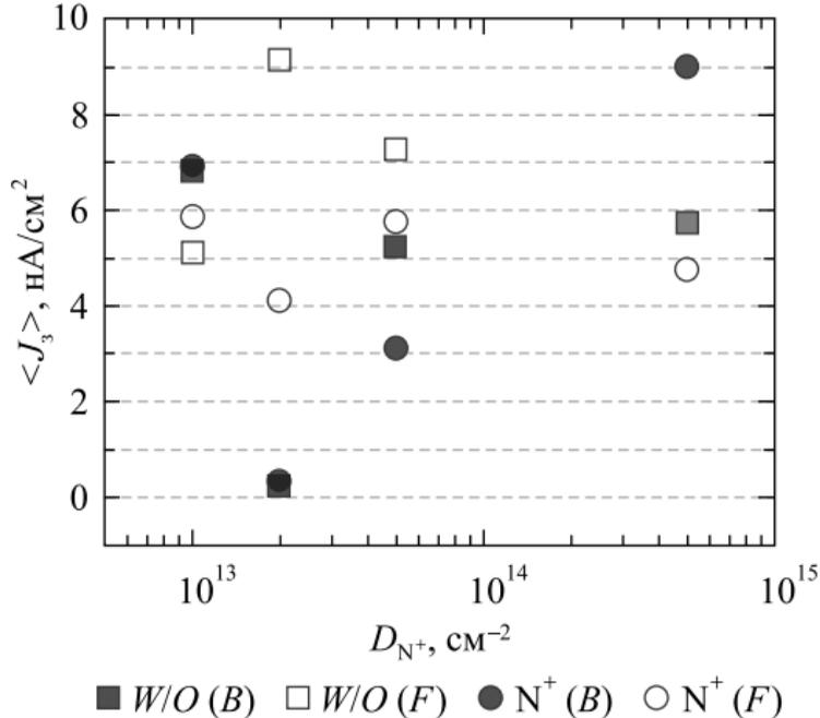
*Рис. 1.* Зависимость средней величины плотности тока утечки затвора транзистора ( $\langle J_3 \rangle$ ) от дозы ИИ азота ( $D_{N^+}$ ) при обратном (B) и прямом (F) порядке термообработки для образцов, имплантированных  $N^+$ , и для контрольных образцов (W/O). Энергия имплантации для доз  $1 \cdot 10^{13}$ ;  $5 \cdot 10^{13}$ ;  $5 \cdot 10^{14}$   $\text{cm}^{-2}$  – 20 кэВ, для дозы  $2 \cdot 10^{13}$   $\text{cm}^{-2}$  – 40 кэВ
