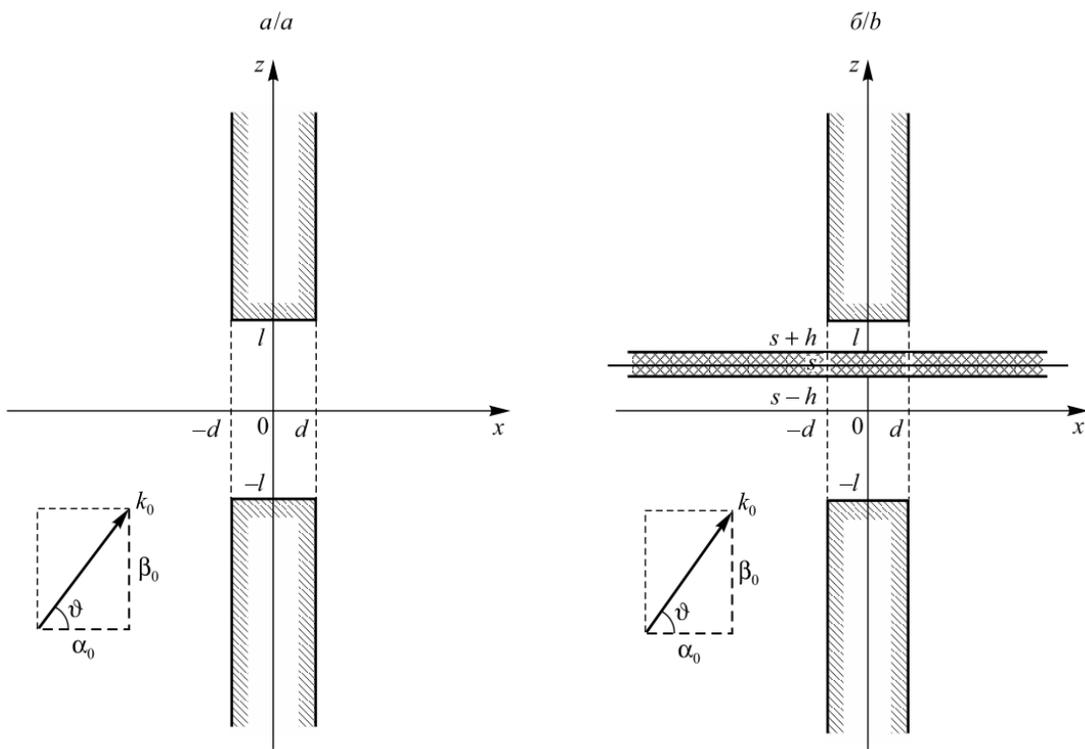
Рис. 2. Схема дифракции плоской волны на щели в проводящем экране конечной толщины:
