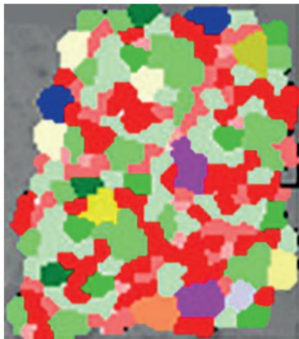
*Рис. 5.* Морфология деформированной части образца под действием тока и СВЧ-излучения (*а*) и в отсутствие тока (*б*) (100-кратное увеличение)
