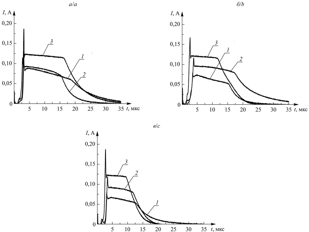
Рис. 5. Ток на подложке при воздействии лазерного излучения с плотностью мощности  $1,8 \cdot 10^9$  Вт/см<sup>2</sup> на различные мишени с постоянными потенциалами в промежутках мишень – сетка (20 В) и сетка – подложка (50 В):
