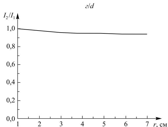
*Рис. 4.* Отношение тока подвижного зонда к току неподвижного зонда при воздействии на алюминиевую мишень лазерного излучения плотностью мощности  $3 \cdot 10^8$  Вт/см<sup>2</sup> при потенциале в промежутке мишень – сетка 20 В и различных потенциалах в промежутке сетка – подложка:
