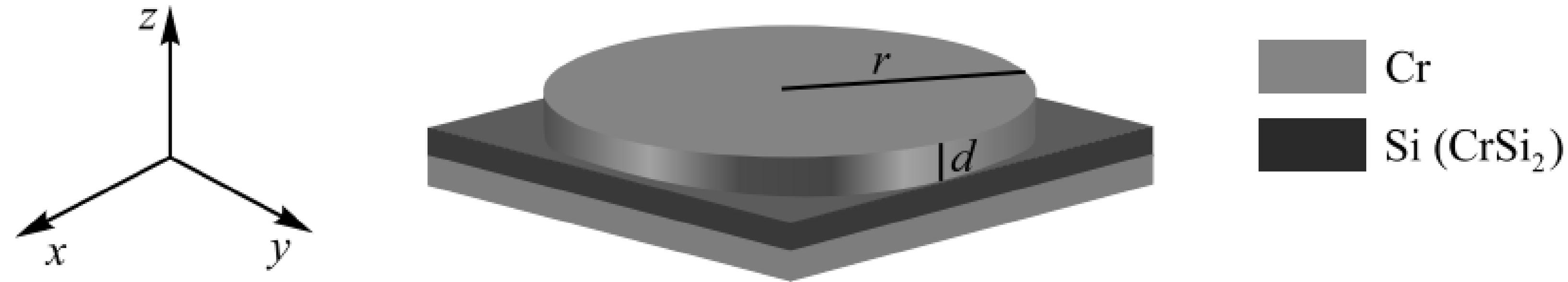
*Рис. 1.* Пиксел моделируемой структуры
