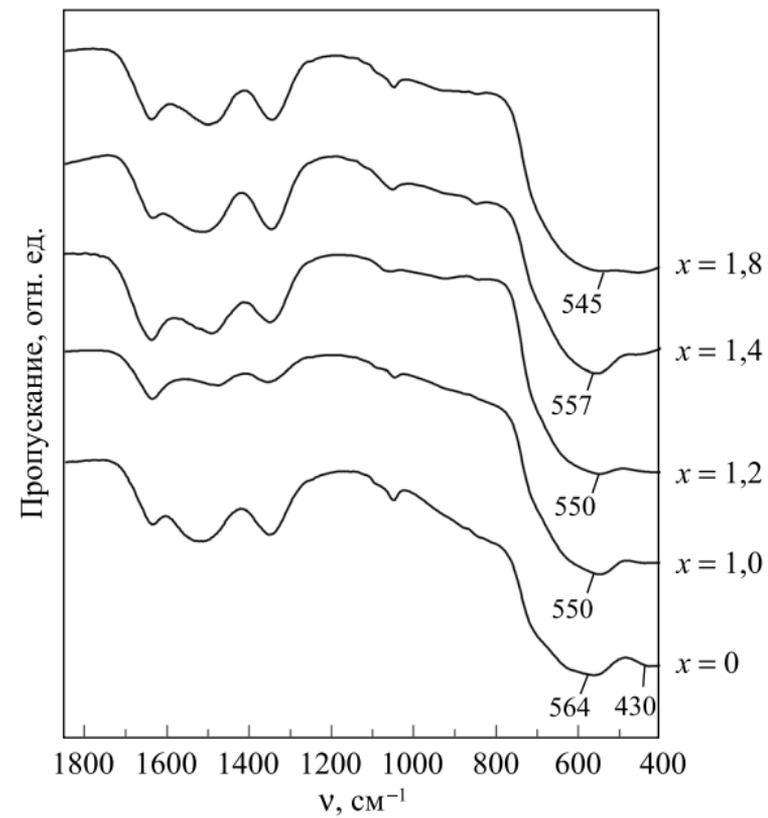
*Рис. 2.* Фрагменты ИК-спектров твердых растворов  $\text{Mn}_x\text{Fe}_{3-x}\text{O}_4$  ( $0 < x < 1,8$ ).
