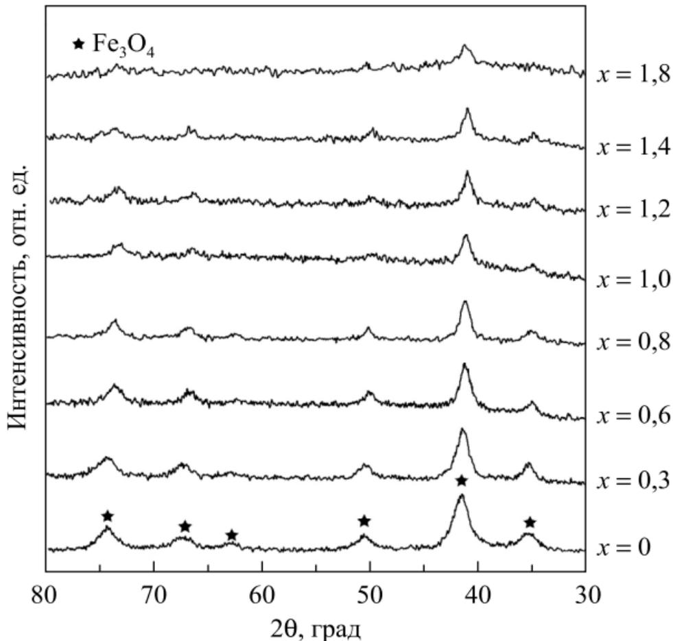
Рис. 1. Спектры РФА порошков  $Mn_xFe_{3-x}O_4$  ( $0 < x < 1,8$ ).
