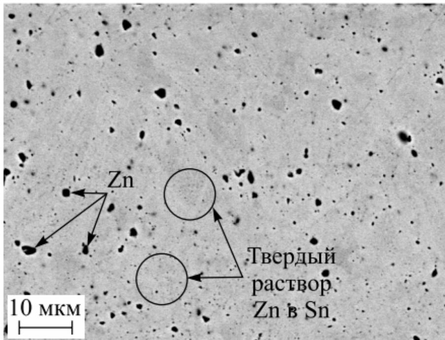
*Рис. 1.* Микроструктура поперечного сечения быстрозатвердевшей фольги сплава Sn – 4,4 мас. % Zn
