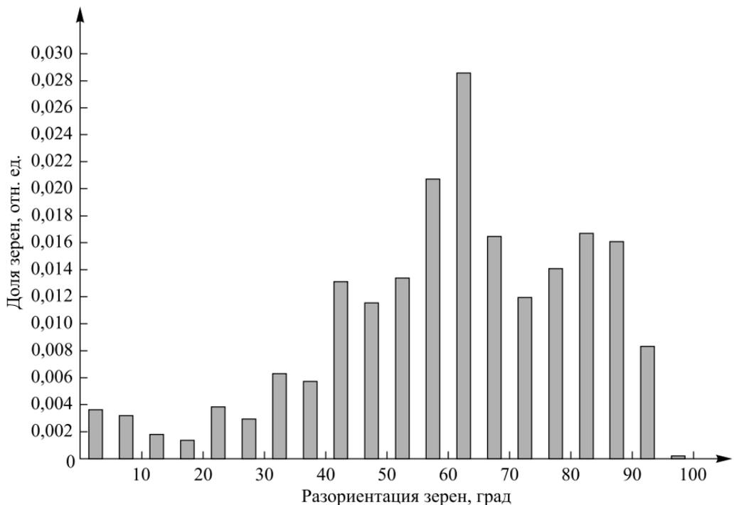
Рис. 4. Разориентация коррелированных границ соседних зерен в слое, прилегающем к кристаллизатору (а), и в слое, контактирующем с атмосферой (б)
