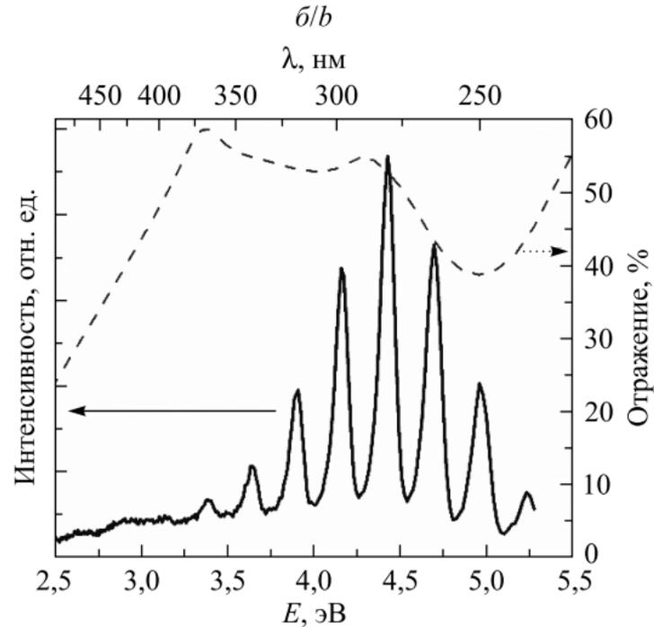
*Рис. 1.* Спектры электролюминесценции структур  $\text{SiO}_2/\text{Si}$ , полученных методами термического окисления (*а*) и плазмохимического осаждения (*б*).
