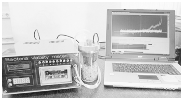
Общий вид лабораторной системы для формирования биоструктур пленочного типа и измерения их зарядовых характеристик
