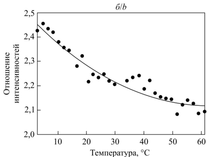
*Рис. 1.* Спектр флуоресценции неодима в образце  $Y_2O_3$  при температуре  $(38,3 \pm 0,1)^\circ C$  (*a*) и аппроксимация температурной зависимости отношения интенсивностей выбранных пиков (880,1 и 915,1 нм) флуоресценции ионов неодима (*б*) (пр. ед. – произвольные единицы)
