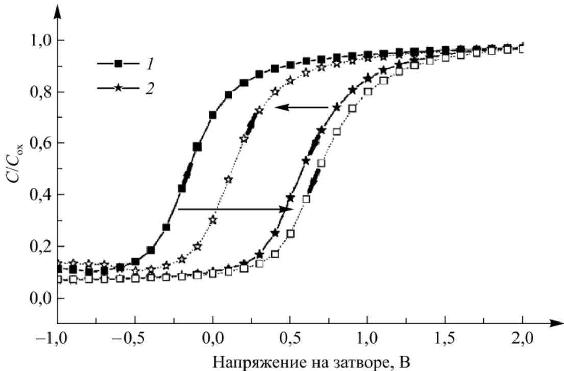
*Рис. 6.* Типичные вольт-фарадные характеристики МОП-структуры с матрицей нанокристаллов Ge в слое SiO<sub>2</sub> при изменении напряжения: 1 – от +5 до –5 В и от –5 до +5 В; 2 – от –5 до +5 В и от +5 до –5 В
