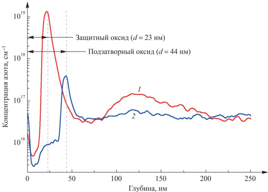
Рис. 3. Профили распределения атомов азота после имплантации ( $D_{N^+} = 5 \cdot 10^{14} \text{ см}^{-2}$ ,  $E = 40 \text{ кэВ}$ ):
