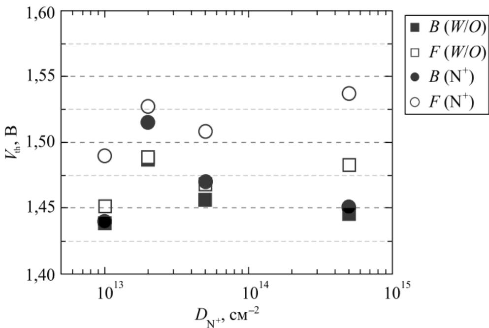
*Рис. 4.* Зависимость величины порогового напряжения ( $V_{th}$ ) транзистора от дозы имплантации азота ( $D_{N^+}$ ) при прямом ( $F$ ) и обратном ( $B$ ) порядке БТО для контрольных ( $W/O$ ) и имплантированных ( $N^+$ ) образцов
