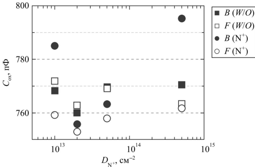
*Рис. 5.* Зависимость величины емкости подзатворного оксида ( $C_{ox}$ ) транзистора от дозы имплантации азота ( $D_{N^+}$ ) при прямом ( $F$ ) и обратном ( $B$ ) порядке БТО для контрольных ( $W/O$ ) и имплантированных ( $N^+$ ) образцов
