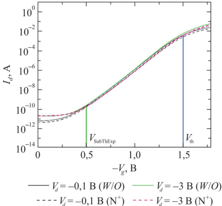
*Рис. 8.* Зависимость тока стока ( $I_d$ ) МОП-транзисторов в триодном режиме ( $V_d = -0,1$  В и  $V_d = -3$  В) от напряжения на затворе ( $V_g$ ) для контрольных ( $W/O$ ) и имплантированных ( $N^+$ ) образцов при обратном порядке БТО ( $D_{N^+} = 5 \cdot 10^{13}$  см<sup>-2</sup>,  $E = 20$  кэВ)
