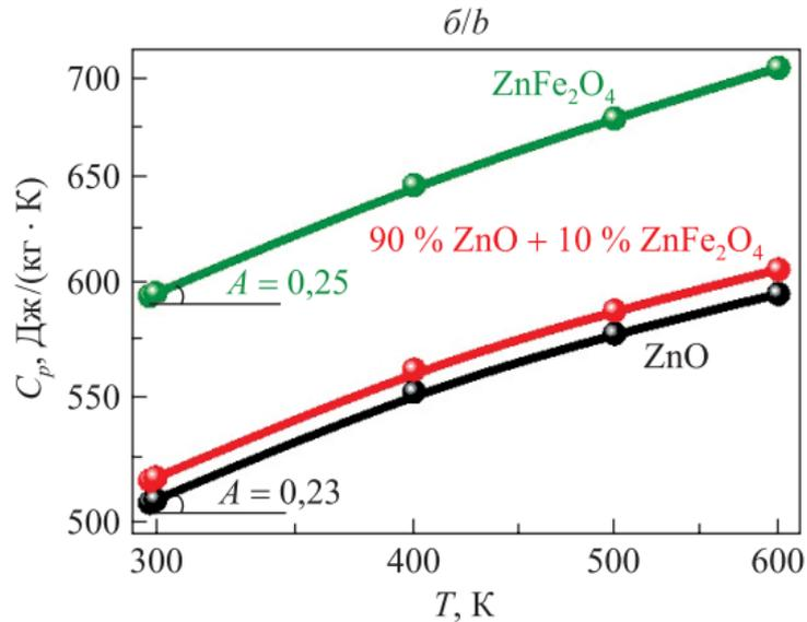
Рис. 3. Температурные зависимости температуропроводности  $\lambda(T)$  керамики в линейном масштабе (а) (1 – ZnO; 2 – ZnO<sub>(90)</sub>FeO<sub>(10)</sub>-2; 3 – ZnO<sub>(90)</sub>Fe<sub>2</sub>O<sub>3(10)</sub>-2) и удельной изобарной теплоемкости  $C_p(T)$  оксида цинка (образец № 1), феррита и отожженной керамики 90 % ZnO + 10 % ZnFe<sub>2</sub>O<sub>4</sub> (образцы № 2 и 3) в двойном логарифмическом масштабе (б).
