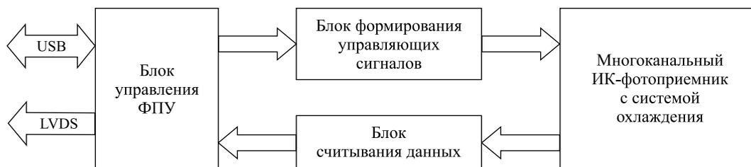
Рис. 2. Структурная схема аппаратуры управления ФПУ
