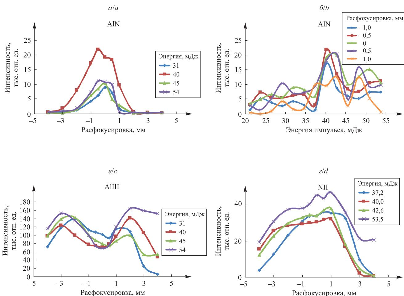
Рис. 1. Зависимость интенсивности полосы AlN (508,0 нм) от расфокусировки (а) и энергии импульсов (б); зависимость от расфокусировки интенсивности линий AlIII (452,92 нм) (в) и NII (399,5 нм) (г)
