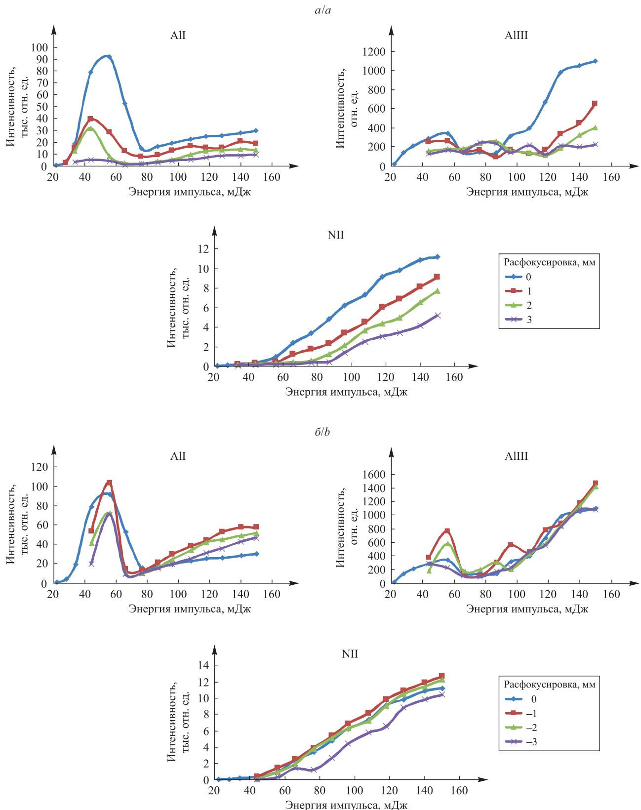
Рис. 2. Зависимость интенсивности линий Al II (394,3 нм), AlIII (452,92 нм) и NII (399,5 нм) в спектрах от энергии импульсов и расфокусировки:
