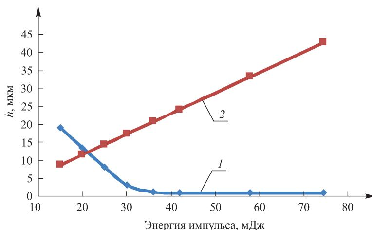
Рис. 3. Зависимость средней толщины испаренного слоя  $h$  за импульс при абляции образца дюралюминия D16T от энергии для времени задержки между первым и вторым импульсами: 1 – 0 мкс; 2 – теоретические значения
