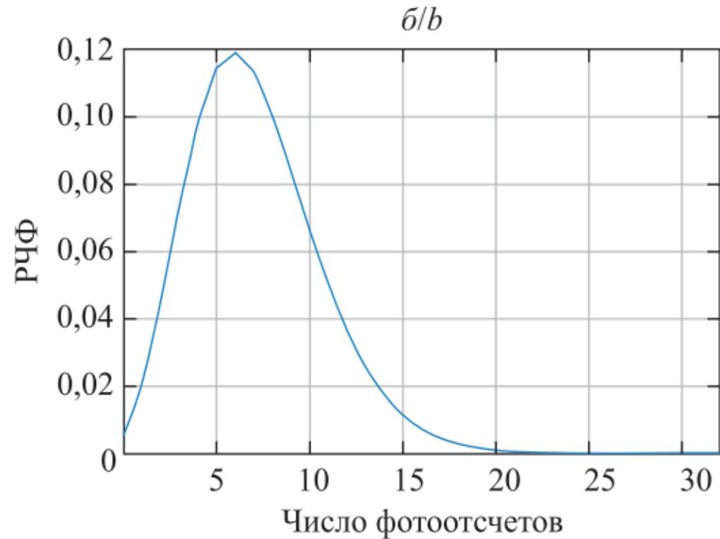
*Рис. 2.* График действительных значений выражения под экспонентой в ПФ (18) (а) и результирующее РЧФ (б)
