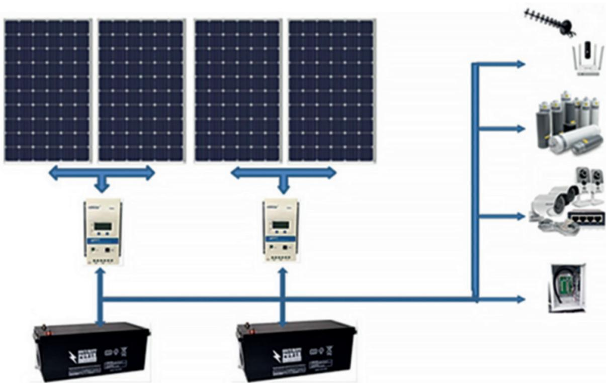
*Рис. 4. Схема солнечной электростанции и подключения оборудования ПРМВК*
