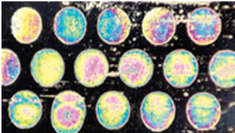
*Рис. 6. Микрофотографии ориентации ЖК в ячейке с квадратной (а) и гексагональной (б) упаковкой массива линз (плоскость ячейки расположена под углом 45° в скрещенных поляризаторах)*
