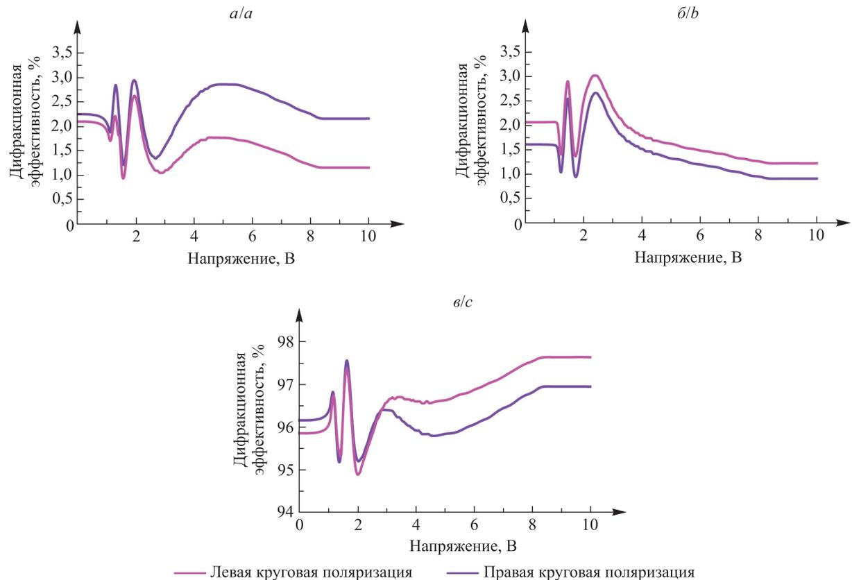
Рис. 7. Зависимости дифракционной эффективности от управляющего напряжения при круговой (левой и правой) поляризации считывающего излучения:
