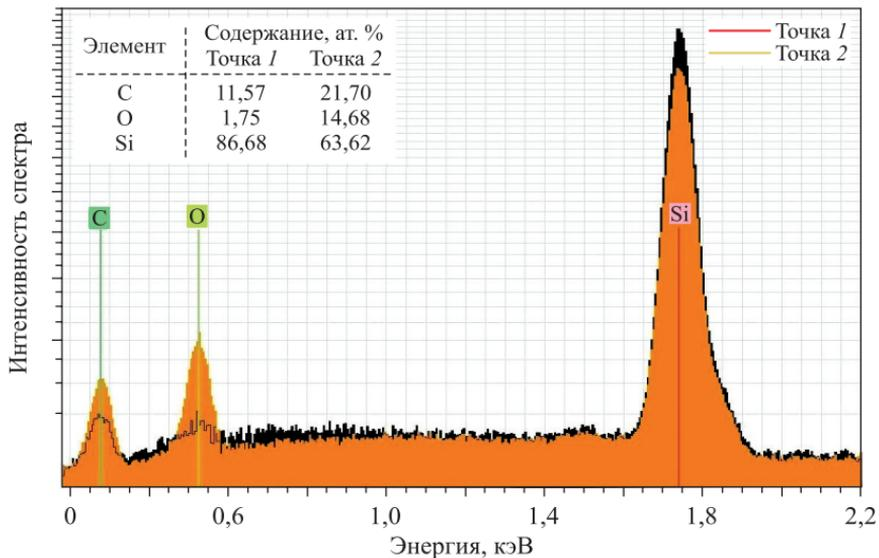
Рис. 5. РЭМ-изображения конгломератов поликремния на поверхности двуоксида кремния без наклона (а) и под наклоном (б), а также их энергодисперсионный спектр (в)
